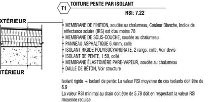
Isolant rigide + Isolant de pente: La valeur RSI moyenne de ces isolants doit être de 6.9
