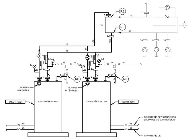
3 DIAGRAMME DE RACCORDEMENT DES CHAUDIÈRES
