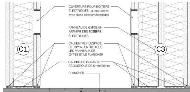
**DÉTAIL MUR TYPE - AU PLANCHER**
